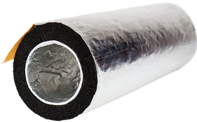
**Firobloc Thermal** kan let tildannes med en kniv så den flugter perfekt med kanten på det omgivende dæk eller væg og stramt rundt om røret. Der røgsikres med Envirograf **AM Akryl Brandmastik** på begge sider. **Firobloc Thermal** er desuden lydisolerende, yder kondenssikring og beskytter mod korrasjon af metalrør.
